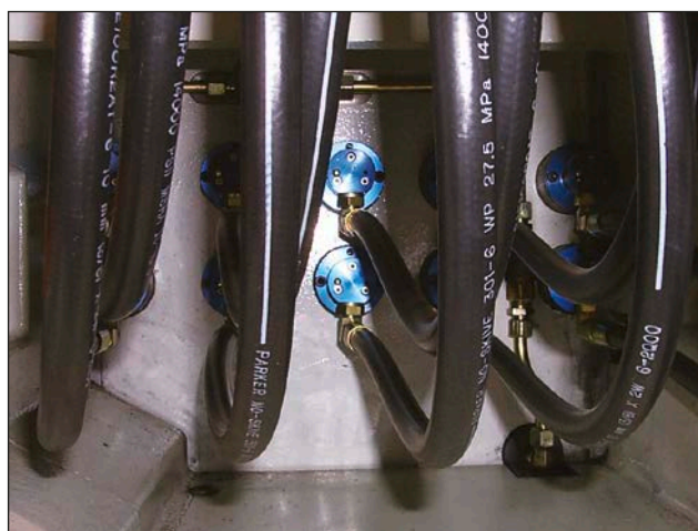
Junta rotativa Deublin sin rodamientos serie 1117 en una máquina Transfer de automoción.
