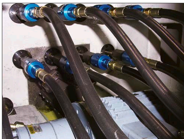
Junta rotativa Deublin soportada por rodamientos serie 1116, en una máquina Transfer de automoción.
