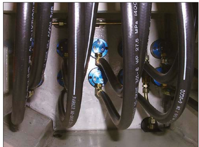
Złącza samonośne Deublin 1117 na linii obróbczej w fabryce podzespołów samochodowych
