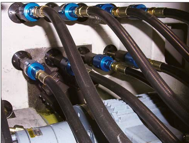
Złącza samonośne Deublin 1116 na linii obróbczej w fabryce podzespołów samochodowych
